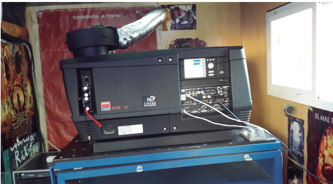
PROYECTOR BARCO DCI INSTALADO EN CABINA MÓVIL FORD TRANSIT.
