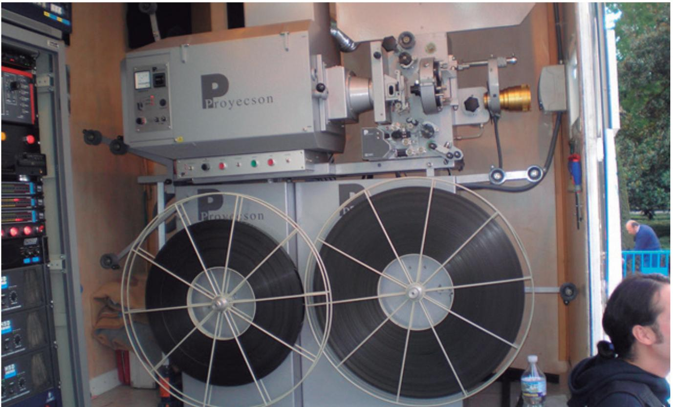
EQUIPO DE PROYECCIÓN 35MM CON LAMPARA XENON DE 7.000W
